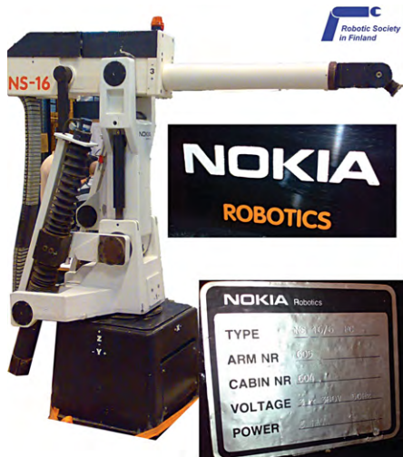
Рис. 1. NS-16 — одна из моделей промышленных роботов компании «Нокиа Роботикс»
